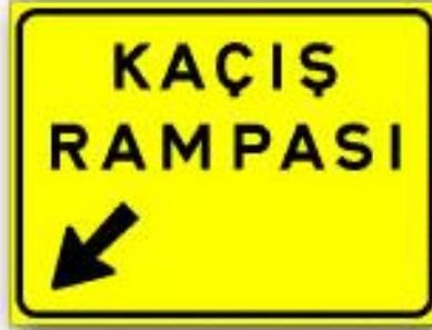
(B-56d) KAÇIŞ RAMPASI (Sol)
